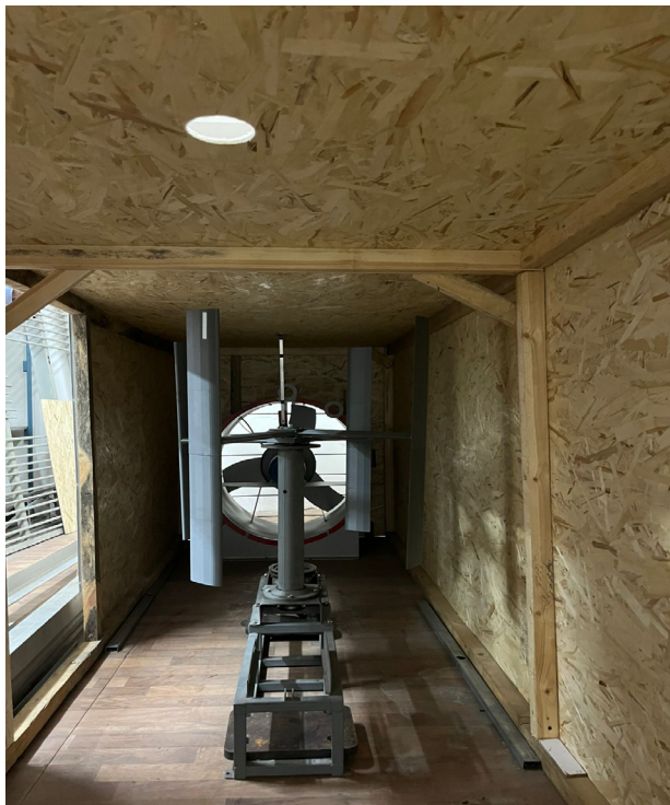
Рисунок 3 – Макет ветроэнергетической установки в рабочей части аэродинамической туннели
