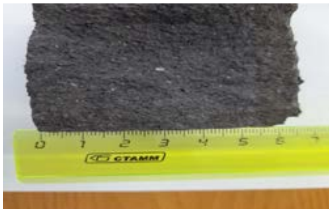
Рисунок 5 – Остаточная толщина отработанной футеровки ковша по шлаковому поясу
