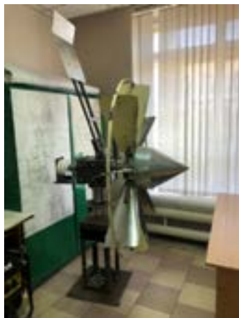
Рисунок 13 – Общий вид ветроэнергетической установки с положением лопастей при скорости ветра соответствующей рабочей и при скорости значительно превышающей рабочую
