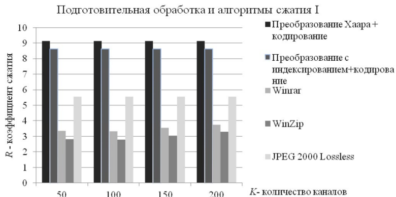
Рисунок 1 – Сравнение алгоритмов сжатия без потерь по степени сжатия
