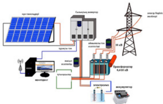
Сурет 2 – PV- фотоэлектрлік күн станциясының жалпы технологиялық схемасы
