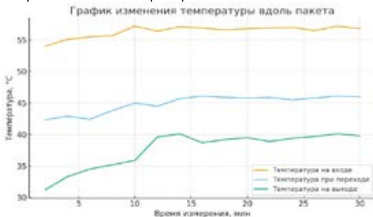
Рисунок 2 – Изменение температуры воздуха на входе, в промежуточной камере и на выходе из плёночного пакета
