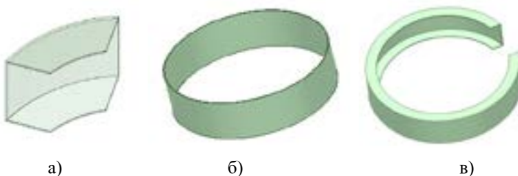
Рисунок 2 – Формы экранов для защиты КИ от внешних МП: (а) П-образный в виде сектора; (б) в виде кольца из полосы металла; (в) П-образный в виде разомкнутого кольца
