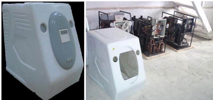
Рисунок 2 – Общий вид теплового преобразователя малой мощности (серии ТП) тепловой мощностью до 10 кВт и его внутреннее устройство
