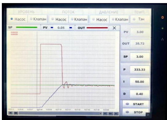
Сурет 7 – Орнатылған PID-реттегіштің графигі
