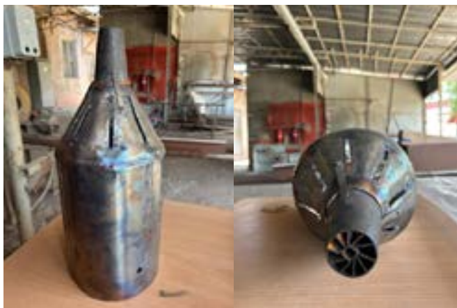
1-сурет – Жылу генераторының перфорацияланған алдыңғы конусы және ауа шүмегі
