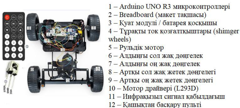
Сурет 6 – Өзірленген мобильді робот платформасының эксперименттік прототипі
