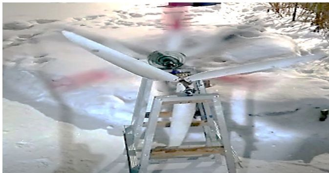
Рисунок – 5 Лабораторный образец ветроустановки со встречновращающимися ветроколесами в ходе испытаний в реальных условиях
