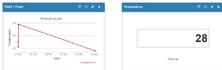
Рисунок 7 – Полученные данные температуры на сервере и отображение результатов в виде графика и цифрового индикатора
