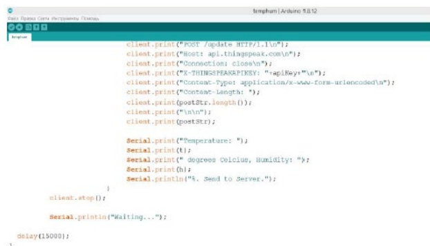
Рисунок 6 – Часть скетча для настройки виджетов сервера для получения результатов измерения
