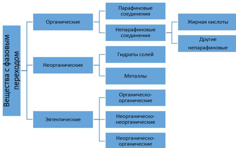
Рисунок 1 – Классификация твердо-жидких ВФП
