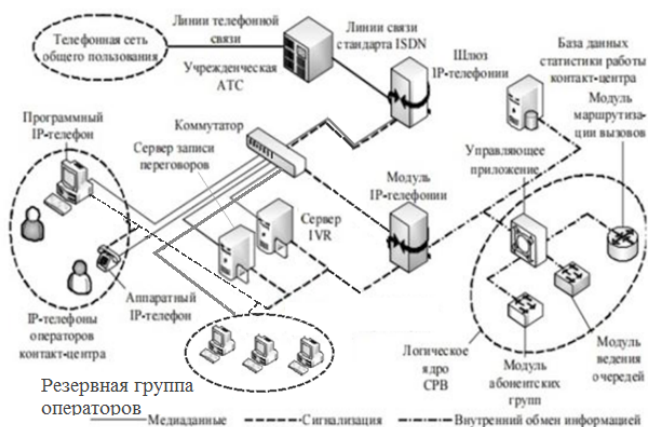
Рисунок 3 – Схема организации контакт-центра с резервной группой операторов
