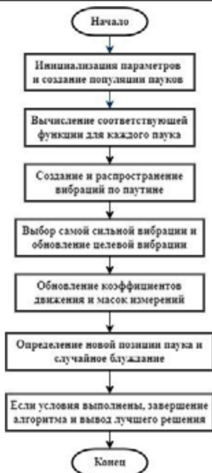
Рисунок 3 – Алгоритм оптимизации социальных пауков для нахождения глобальной точки максимальной мощности
