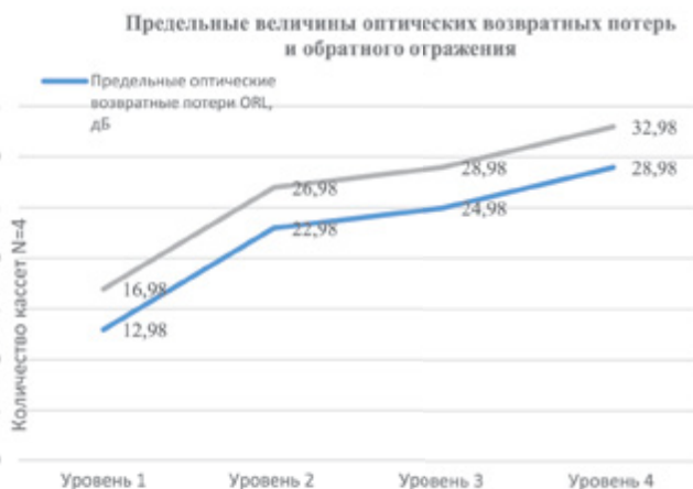
Рисунок 2 – Показатели значений предельных оптических возвратных потерь и предельных величин обратного отражения для муфтового соединения с числом кассет N=4
