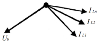
Рисунок 6 – Векторная диаграмма токов и напряжения нулевой последовательности при повреждении на шинах
