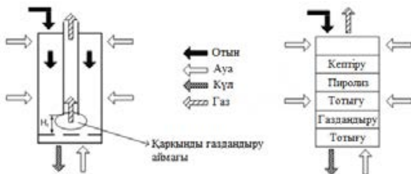
9-сурет – GazEla газ генераторының схемалық диаграммасы
