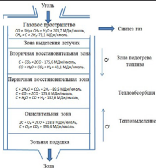
Рисунок 2 – Реакционные зоны в газификаторе
