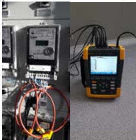
Рисунок 3 – Измерение с помощью анализатора «FLUKE 437»
