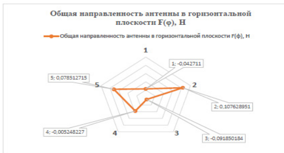
Рисунок 2 – Общая направленность антенны в горизонтальной плоскости
