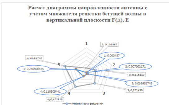
Рисунок 3 – Расчет диаграммы направленности антенны с учетом множителя решетки бегущей волны в вертикальной плоскости F( \Delta ), E
