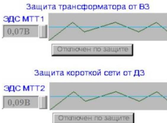
Рисунок 5 – Мнемосхема на экране HMI панели
