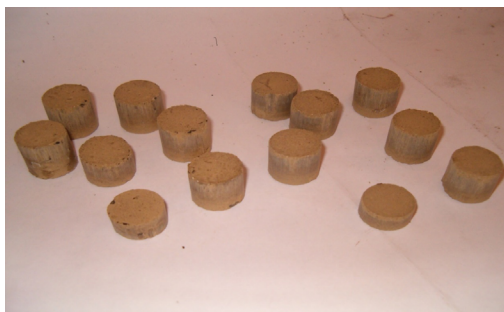
Рисунок 1 – Брикеты полученной из никелевой руды
