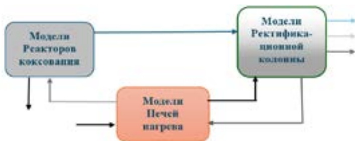
Рисунок 1 – Схема объединения моделей основных взаимосвязанных агрегатов УЗК в единую систему моделей
