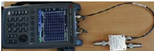
Рисунок 11 – Схема измерения КСВ обратного порта делителя
