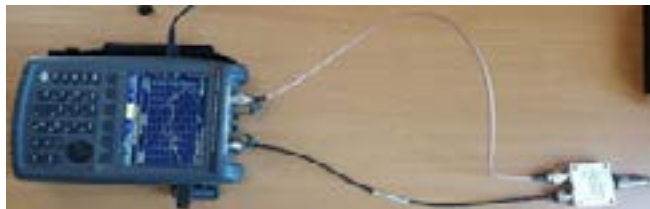
Рисунок 12 – Схема измерения переходного ослабления (развязка, изоляция)
