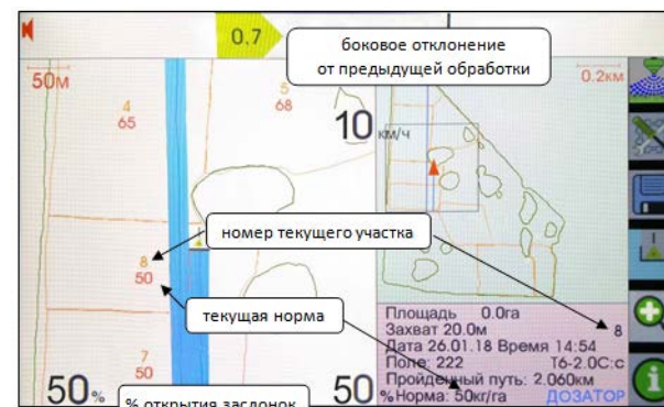
Рисунок 4 – Вид рабочего экрана во время работ по дифференцированному внесению удобрений
