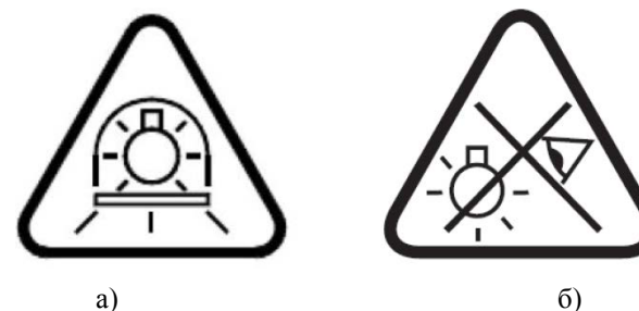
Рисунок 3 – Обозначение на светильнике в соответствии с IEC 60598-1
