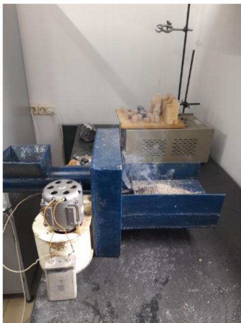
Рисунок 1 – Разработанная конструкция ретортной горелки
