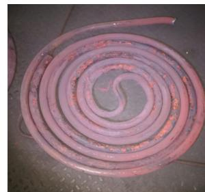
Рисунок 2 – Наружная поверхность труб змеевиков
